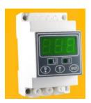
Мультифункциональный автомат защиты по напряжению и току БАРЬЕР-9. Монтаж на DIN-рейку. Также может использоваться в качестве ограничителя тока. Коммутируемый ток до 40A (мощность до 8,5 КВт). Настраиваемые параметры срабатывания. Ручное включение-выключение.
