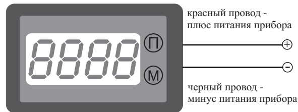
Рис.1. Подключение прибора. Допустимо питание как постоянным, так и переменным током.
