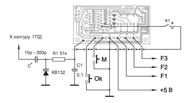
Рис.2 Схема подключения шкалы к трансиверу.
