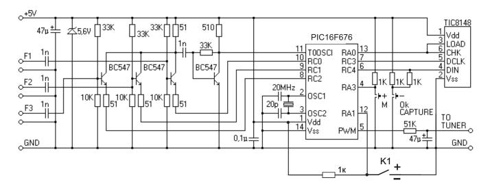
Рис.1 Принципиальная схема шкалы.
