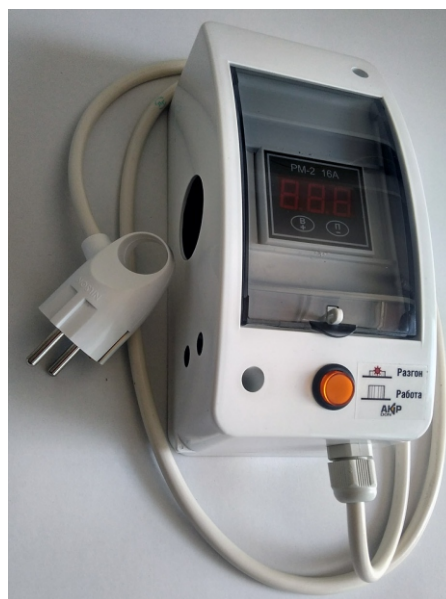
Рис. 2. Внешний вид прибора. Вилка - на проводе, розетка - встроена в боковой стенке прибора.
