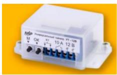
Универсальный таймер УТ-12В предназначен для формирования необходимых выдержек времени в различных технологических процессах, работает с интервалами времени работы и простоя от 0,1 секунды до 25 часов. Питание 12 V AC\DC, максимальный коммутируемый ток — 10 Ампер.
