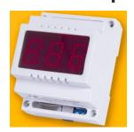
Электронный вольтметр переменного тока В-08К на дин-рейку служит для индикации действующего напряжения переменного тока в бытовых и промышленных цепях. Разрешающая способность — 1 Вольт, диапазон измерений — от 25 до 400 Вольт. Монтаж на din-рейку, эквивалент 4 стандартных токовых автоматов.
