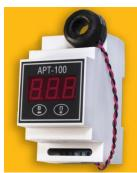
АРТ-100 предназначен для измерения силы переменного тока частотой 50 Гц (до 100 А), а также для отключения нагрузки (или подачи сигнала) при превышении тока, понижении тока (холостой ход), заданного в параметрах прибора. Может работать в режиме ограничителя тока. Комплектуется собственным датчиком тока.
