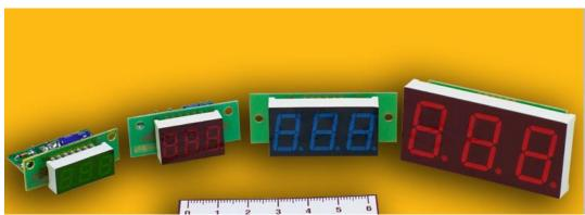
Электронный амперметр постоянного тока АПТ-75мВ служит для измерения истинного среднеквадратического (*True RMS*, *или TRMS*) значения величины силы постоянного тока. Предназначен для работы с любыми внешними стандартными измерительными шунтами: 50A, 75A, 100A, 150A, 200A, 300A, 500A, 750A, 1000A. Питание от постоянного или переменного тока.
