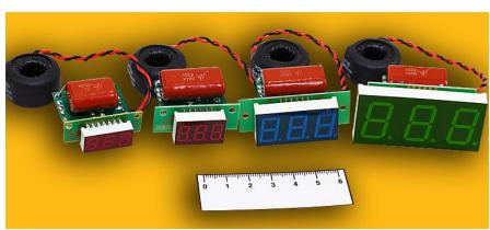
Электронный амперметр переменного тока (A-028, A-036, A-056, A-08) служит для измерения истинного среднеквадратического (*True RMS*, *или TRMS*) значения величины силы переменного тока до 100 Ампер. Разрешающая способность — 0,1 А, диапазон измерений — от 0,0 до 99,9 А. Измерительный трансформатор в комплекте.
