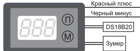
Во время прерывистого звукового сигнала цифры на индикаторе гаснут в противофазе звука. Если прибор настроен на постоянный звуковой сигнал, то цифры на индикаторе не гаснут. Во всех случаях после последнего нажатия любой из кнопок система через 5 секунд выходит в основной режим (индикация температуры и отработка заданных параметров) с сохранением изменений.
