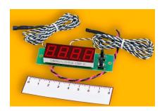
Встраиваемый многоканальный измеритель температуры T-056МК предназначен для дистанционного контроля температуры от одного до десяти датчиков температуры DS18B20. Диапазон измерения — от -50,0 до +125,0 °C, разрешающая способность — 0,1 °C. Питание 12 V DC.
